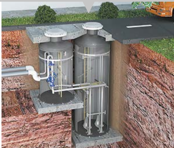
КНС с погружными насосами и выносной запорной арматурой
